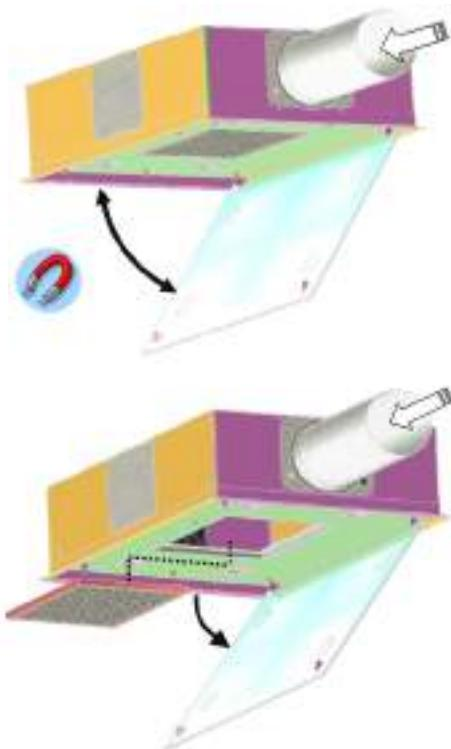
Metallfilter nach dem Reinigungsprozess wieder einsetzen, die Glasscheibe mit beiden Händen wieder anheben sowie anschließend die Taste **1** (Fernbedienung) gedrückt halten (15 sec.), der Betriebsstundenzähler wird dadurch zurückgesetzt und die rote LED erlischt.
