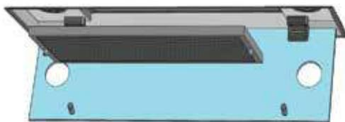
Der Einbau des Metall-Fettfilters und das Schließen der Glasscheibe erfolgen in umgekehrter Reihenfolge.
