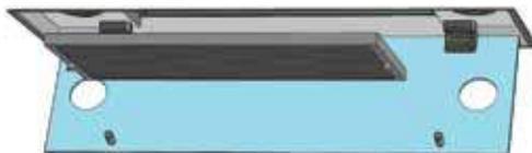
De installatie van het metalen vetfilter en het sluiten van de glasplaat gebeurt in omgekeerde volgorde.
