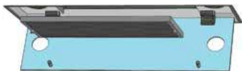
L'installation du filtre à graisse métallique et la fermeture de la vitre sont effectuées dans l'ordre inverse.
